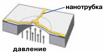
9 Конструкция датчика давления на основе однослойной трубки (Phys. Rev. Lett. 2001, 86, 2416). Сопротивление нанотрубки зависит от ее натяжения, а оно — от прогиба мембраны
